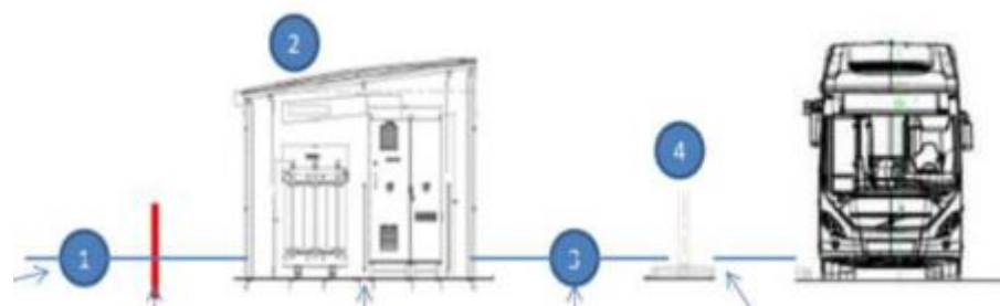
1. Punto de conexión; 2. Mini-subestación; 3 y 4. Sistema de conexión del cargador
